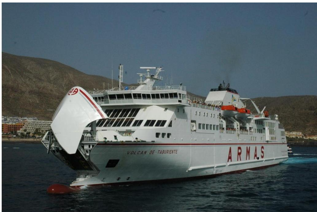
con objeto de agilizar las maniobras. Dispone de dos hélices de maniobra a proa de 720 KW, que utiliza sobre todo en La Gomera, donde tiene que girar 180° para atracar de popa. En Los Cristianos atraca de proa y sólo las utiliza para la aproximación al muelle. Una evolución impresionante
