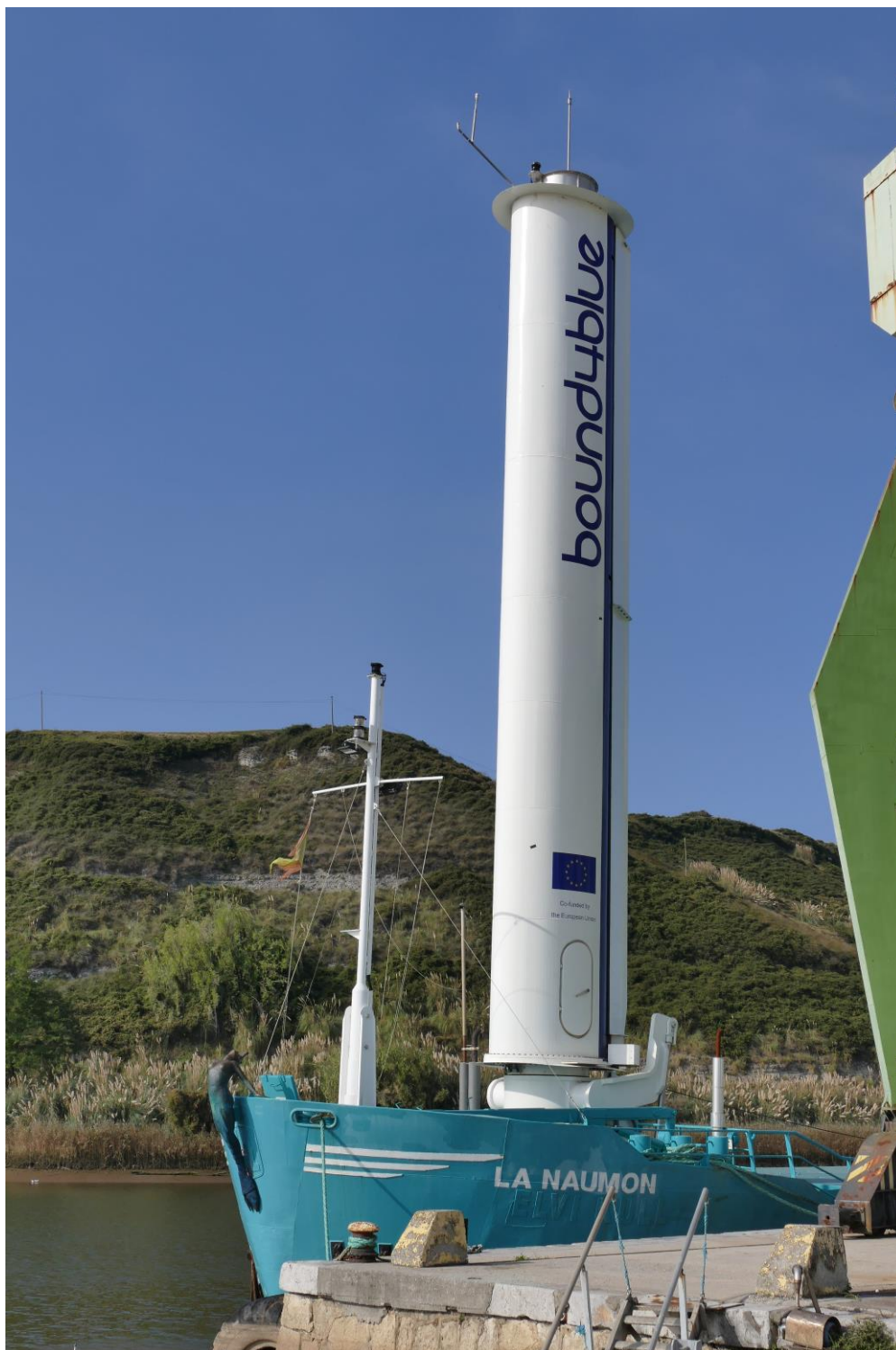
Detalle de la vela rígida y del mascarón de proa instalados en LA NAUMON
